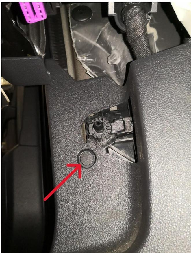
17. Drehen Sie die Schraube heraus und entfernen Sie den Befestigungsclips.
