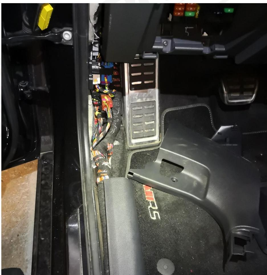
20. Befestigen Sie einen stabilen Draht o.ä. an Ihrer Durchzughilfe. Dadurch ist ein Durchstechen nach vorne leichter. Führen Sie den Draht hinter dem Gurthalter in die vordere Türeinstiegsleiste.
