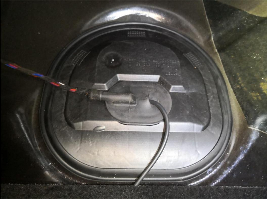
8. Führen Sie das Kabel hinter dem Stoff zur Fahrerseite herüber.
