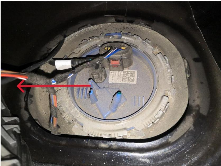
4. Die Durchzugshilfe entlang der rot markierten Pfeile verlegen. Immer möglichst oberhalb von Fahrzeugteilen verlegen.
