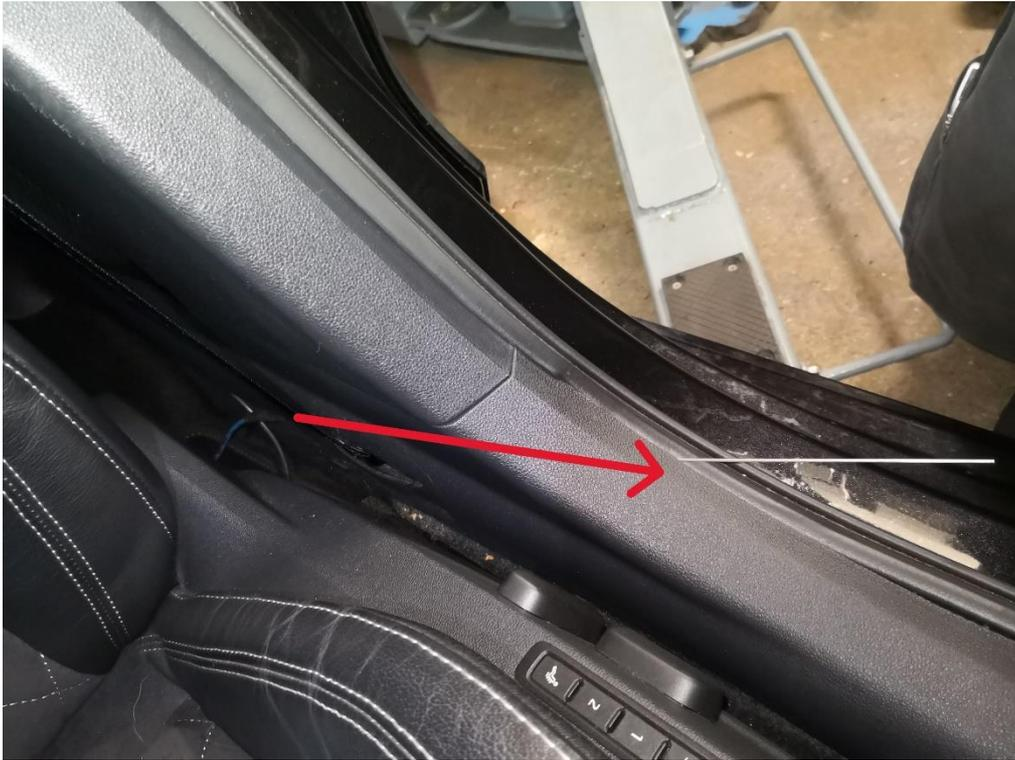
21. Legen Sie das Kabel entlang der originalen Kabel zu den Steckverbindungen.
