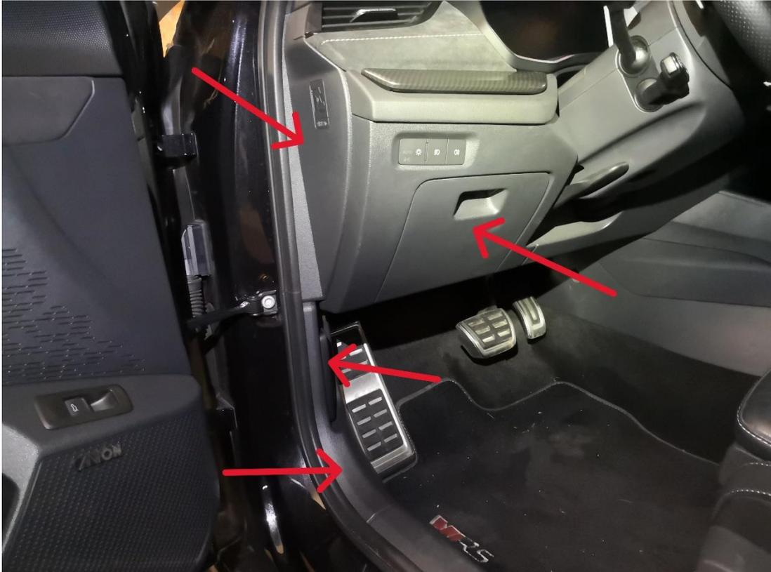
13. Entfernen Sie die seitliche Abdeckung mit einem geeigneten Kunststoffwerkzeug.
