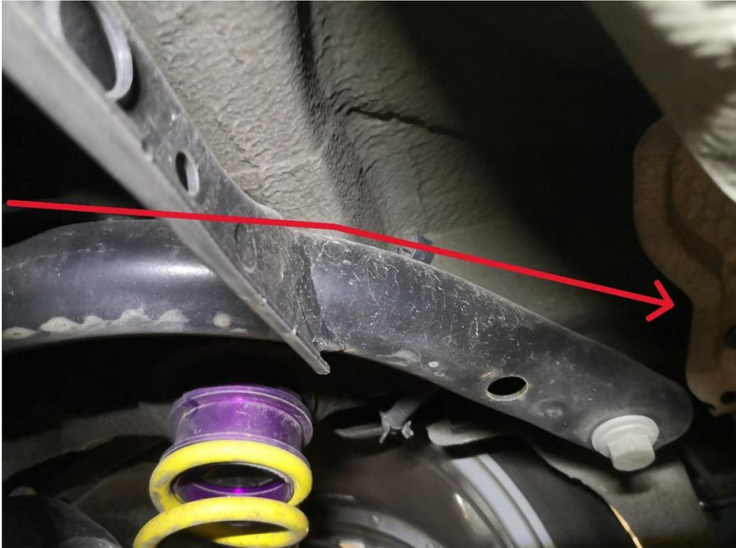
5. Entfernen Sie die Schraube vom Hitzeschutzblech und biegen Sie dieses leicht nach unten um darüber mehr Platz zum Durchführen des Kabels zu erlangen.
