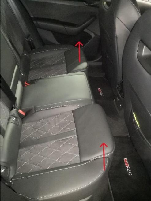
2. Benzinpumpendeckel herausnehmen. Dazu das Gummi eindrücken, mit zwei Fingern hineingehen (Richtung Fahrzeugheck) und den Benzinpumpendeckel vorsichtig nach oben ziehen.
