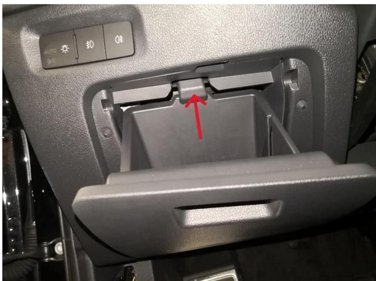
15. Ziehen Sie die Motorhaubenentriegelung leicht nach vorne und entfernen Sie den Arretierungsclips in Fahrtrichtung.
