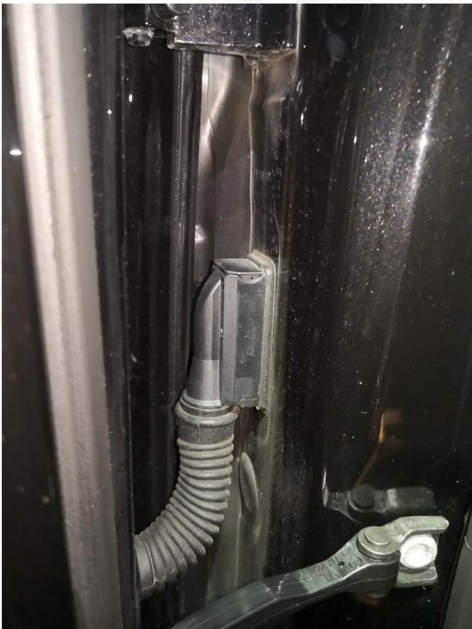
34. Schließen Sie nun das zuvor verlegte Kabel von den Klappen an die Steuerung an.
