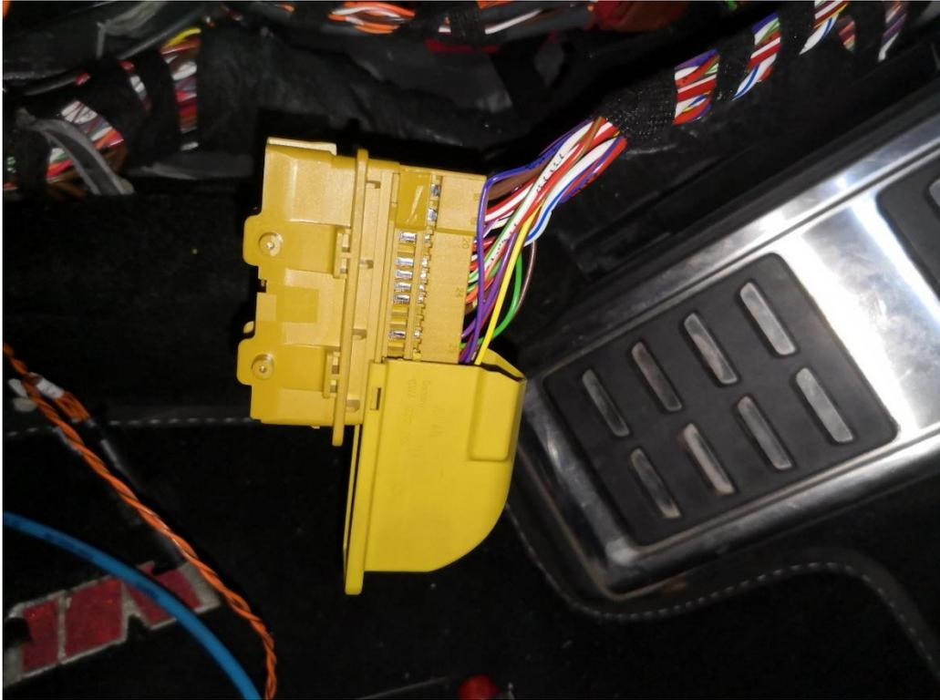
29. Pinnen Sie die folgenden Kabel aus, indem Sie die **rot** markierte Stelle leicht drücken und das Kabel herausziehen:
