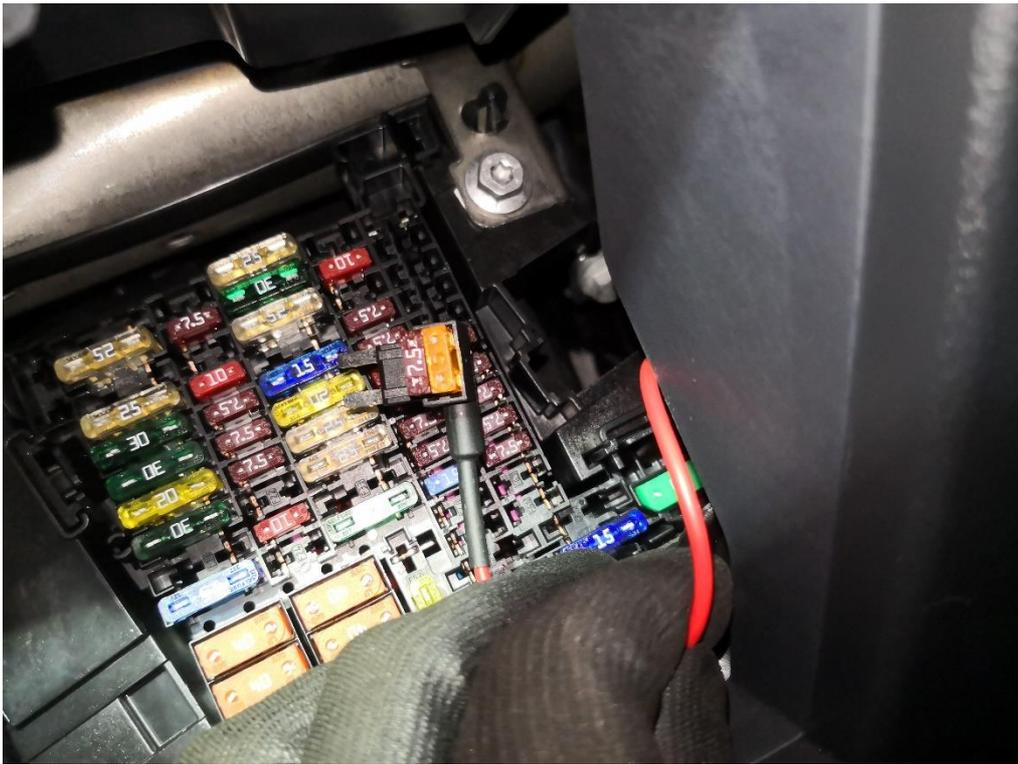
25. Stecken Sie den Sicherungshalter an die Position wo Sie zuvor die Sicherung entfernt haben.
