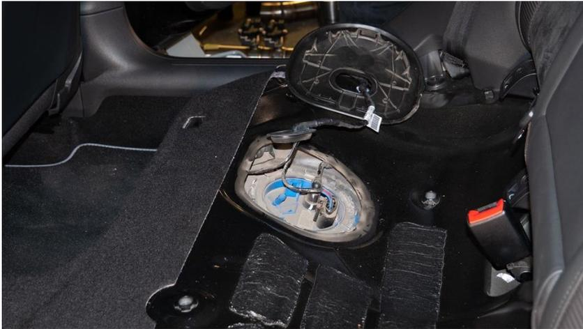
3. Nun eine Durchzugshilfe über den Tank Richtung Beifahrerseite führen und nach unten herausziehen.
