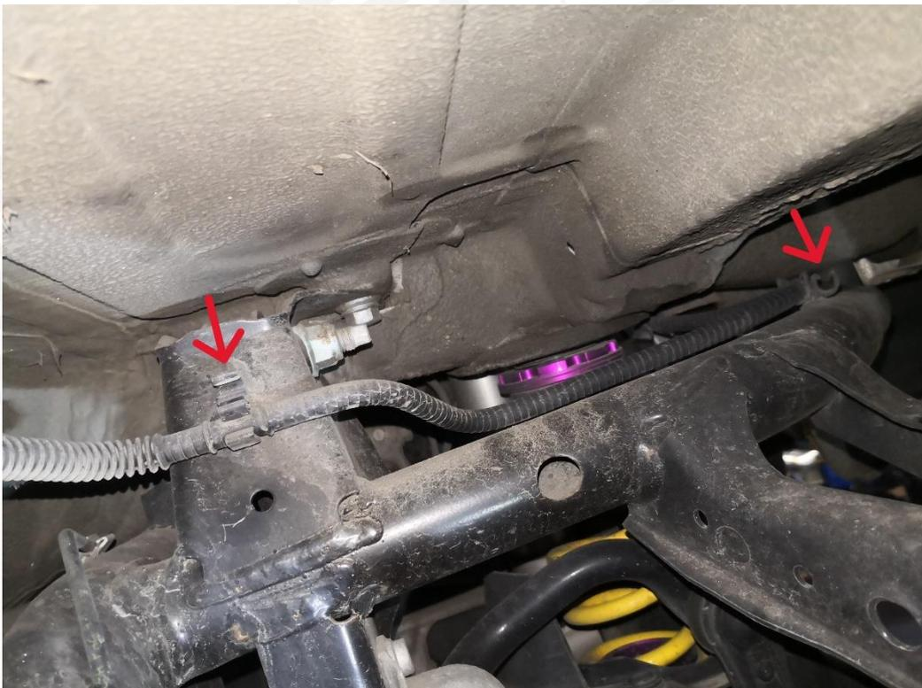
7. Schneiden Sie die Gummitülle kreuzförmig ein und führen Sie das Kabel hindurch.
