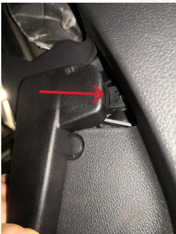
16. Entfernen Sie den Hebel. Nun entfernen Sie die rot markierte Abdeckung.
