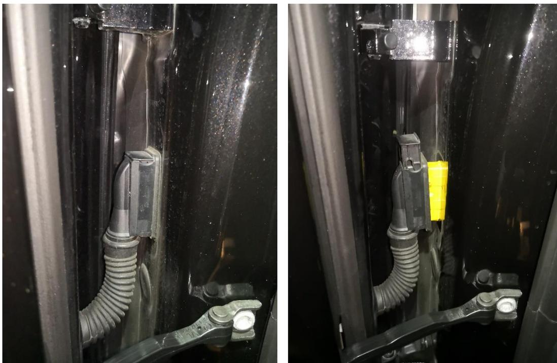
19. Ziehen Sie die Türeinstiegsleiste mit einem Ruck nach oben und entfernen Sie dann die Verkleidung der Elektronik.
