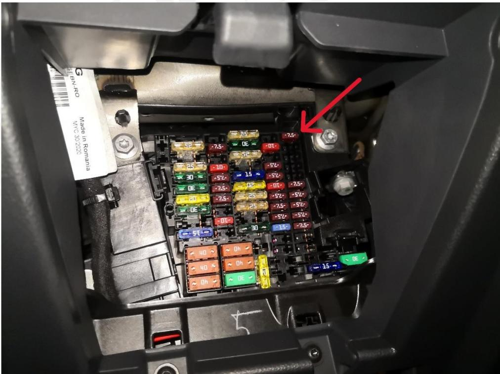
24. Stecken Sie die herausgezogene Sicherung in den Sicherungshalter neben die bereits vorhandene Sicherung.
