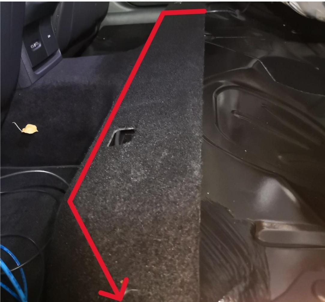
9. Führen Sie das Kabel hinter der Verkleidung nach vorne.
