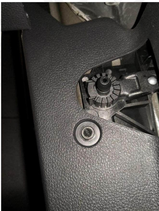
18. Ziehen Sie den Entriegelungsclip des Steckers der Türelektronik nach oben.
