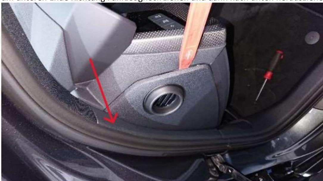
3. Drehen Sie die vier **rot** markierten Schrauben der unteren Armaturenbrettverkleidung heraus und ziehen Sie diese Richtung Fahrzeugheck weg.
