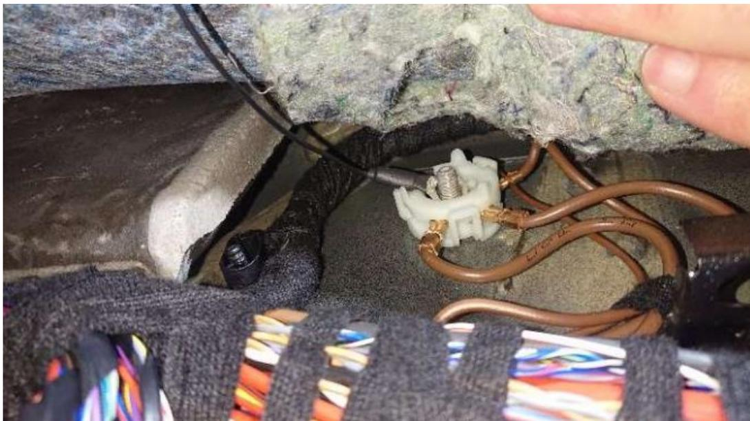
6. Trennen Sie die **grüne** Steckverbindung (**blauer** Pfeil) und stecken Sie das mitgelieferte Modul zwischen die beiden Verbindungen. Trennen Sie ebenfalls die **braune** Steckverbindung (**roter** Pfeil).
