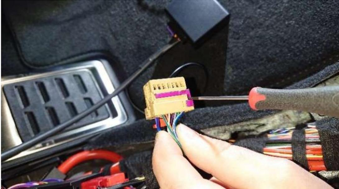
8. Nun werden Pin2 (**orange/braun**) und Pin3 (**pink**) aus dem Stecker entnommen. Hierzu mit einem kleinen Schraubendreher leicht in die Vertiefung drücken, um den Widerhaken zu lösen.
