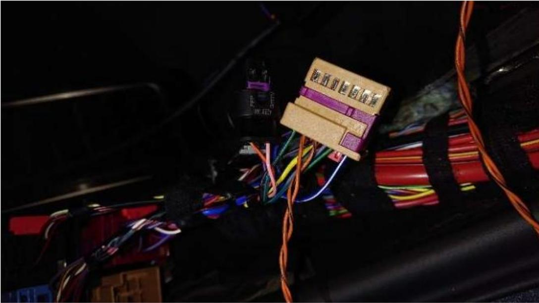
10. Stecken Sie nun den 2-poligen Stecker zusammen und positionieren Sie diesen an geeigneter Stelle.
