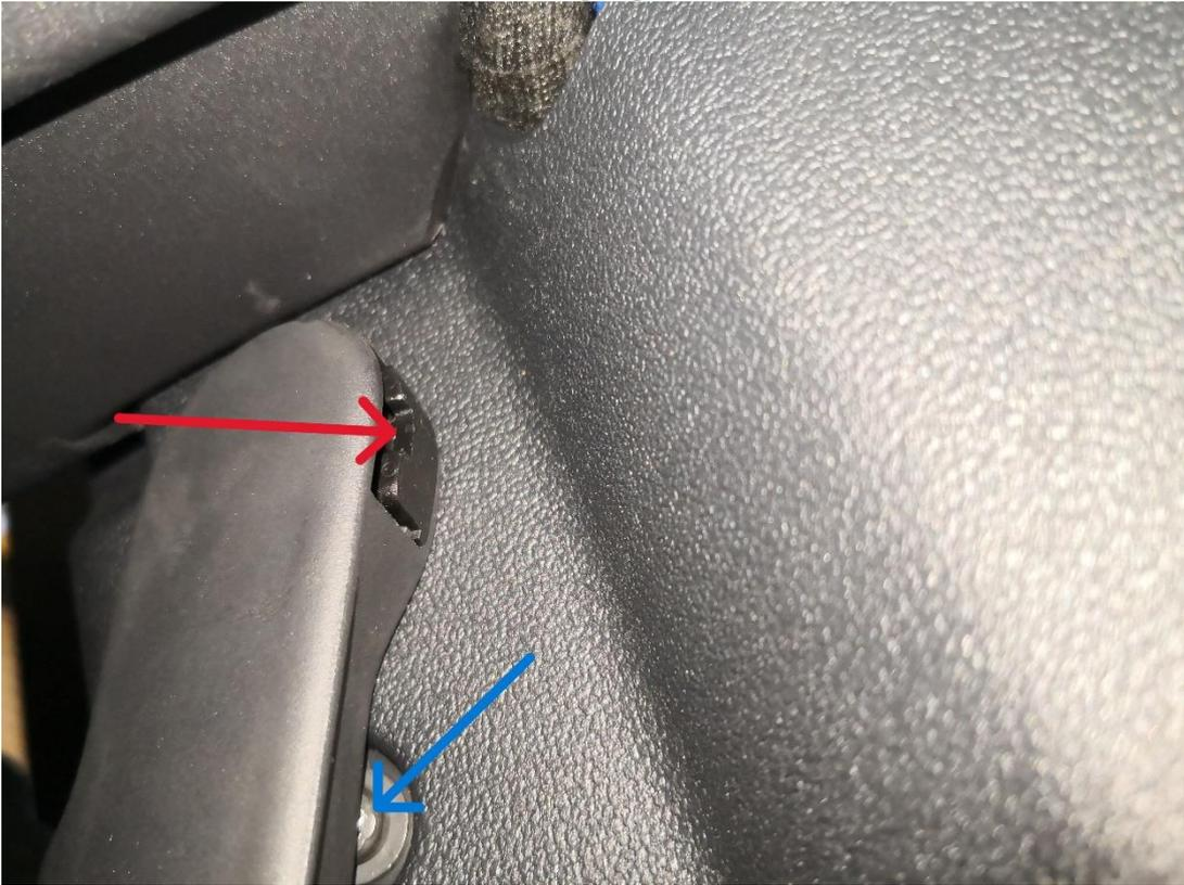
5. Demontieren Sie die Einstiegsleiste, indem Sie zunächst im **rot** markierten Bereich nach oben ziehen und dann das gesamte Bauteil in Richtung Fahrzeugheck entnehmen. Unterhalb des Kabelbaums an der **gelb** markierten Stelle finden Sie den Massepunkt, wo Sie die Masseleitung mit der Ringöse an einer freien Position anschließen.
