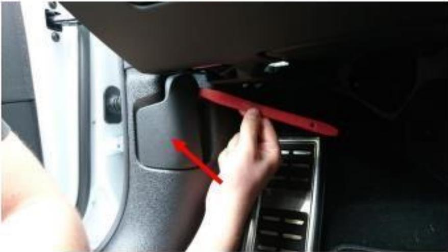
Danach den Hebel zum Öffnen der Motorhaube demontieren:
