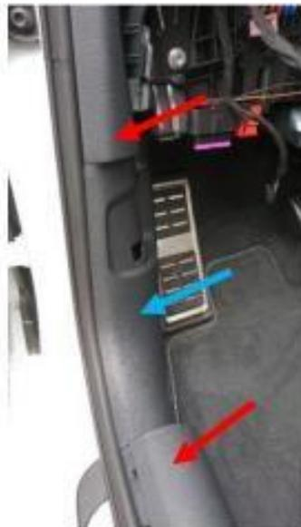
Die obere Verkleidung ebenfalls „ausklipsen“ oder komplett demontieren.
