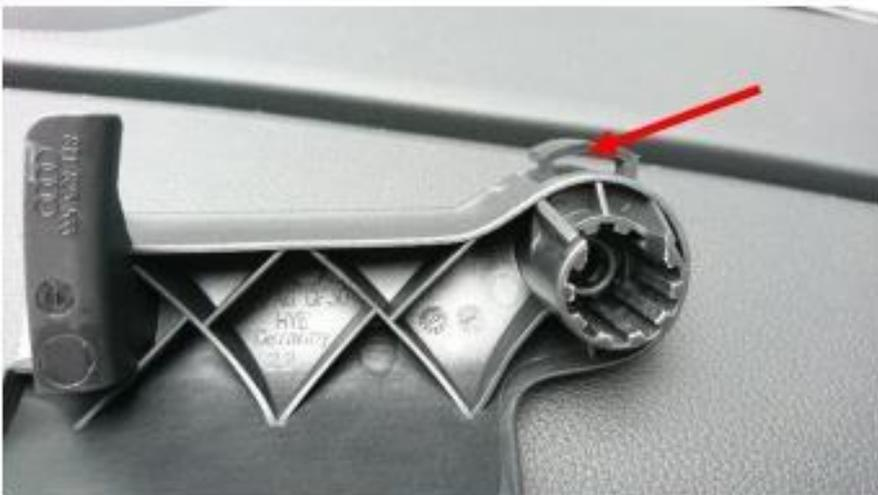
Zum Abnehmen die Verriegelung entfernen und den Hebel gleichzeitig nach vorne und zur Seite ziehen
