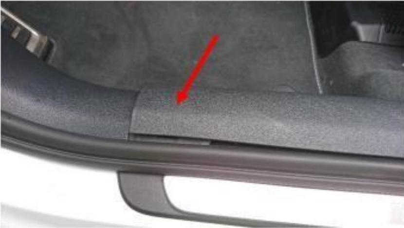
Dann die Abdeckung an der Fahrerseite im Fußraum lösen.
