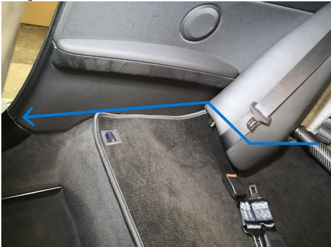
16. Führen Sie das Kabel in der Einstiegsleiste in den Beifahrerfußraum.
