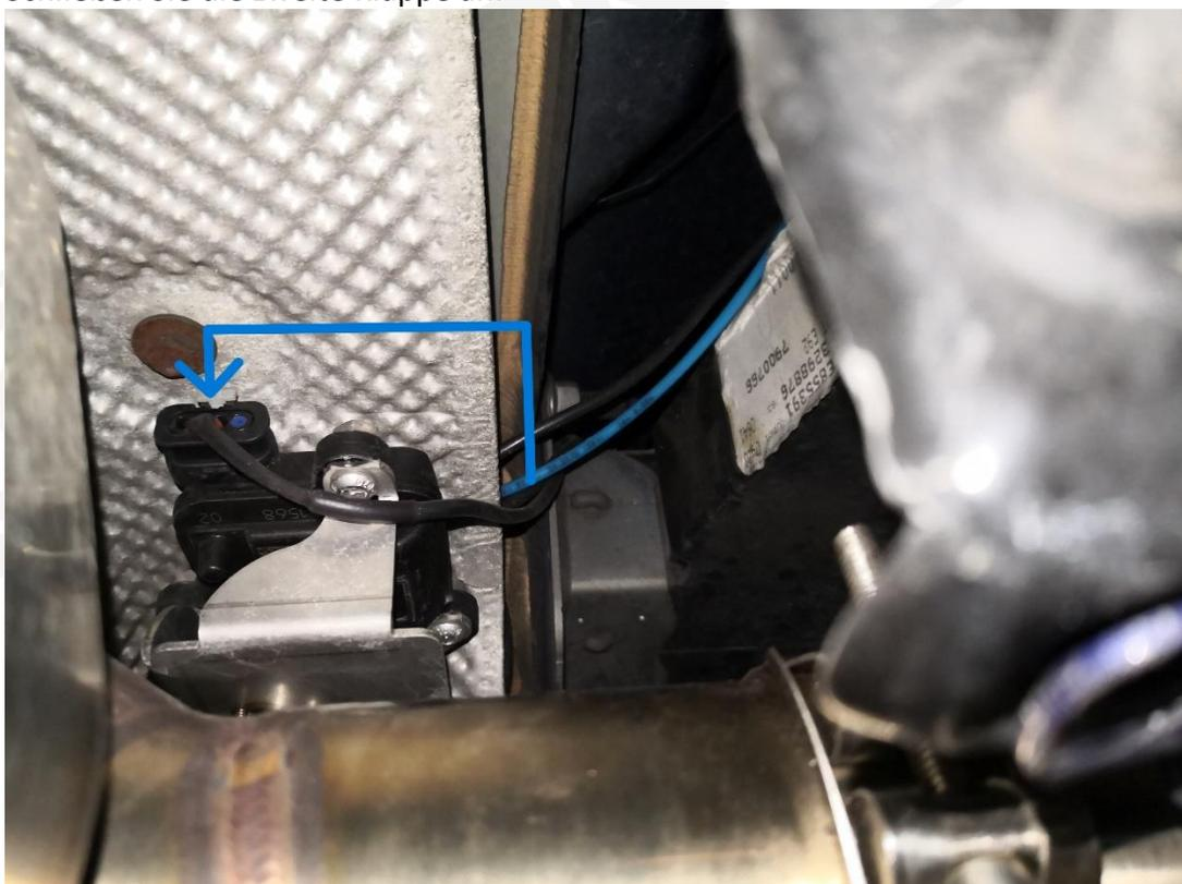
9. Verlegen Sie das Kabel oberhalb des Hitzeschutzbleches Richtung Fahrzeugfront. Wenn nötig lösen Sie hierfür die Befestigungen ein wenig.
