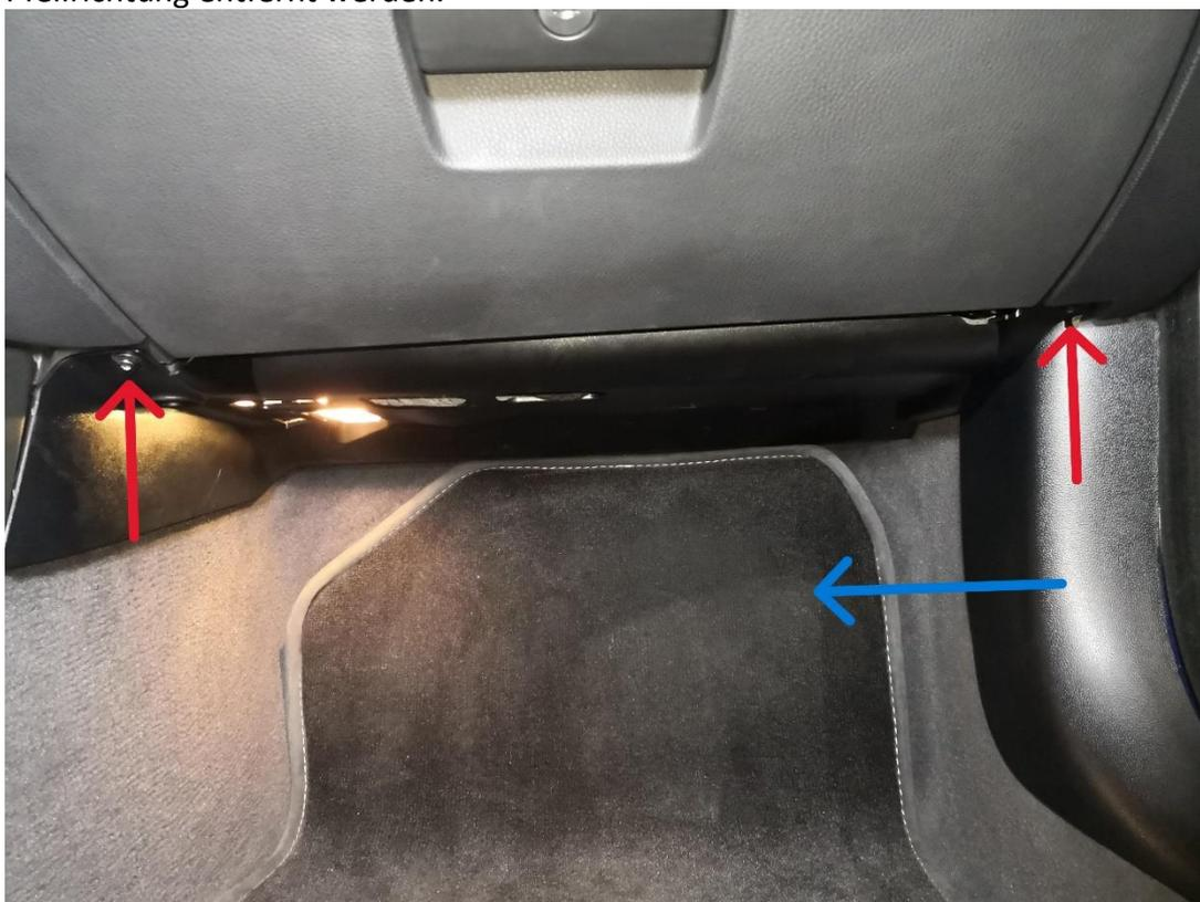
14. Öffnen Sie das Handschuhfach und drehen Sie die beiden Verriegelungen um jeweils 90°. Nun können Sie die Abdeckung entfernen und erhalten freie Sicht auf den Sicherungskasten.
