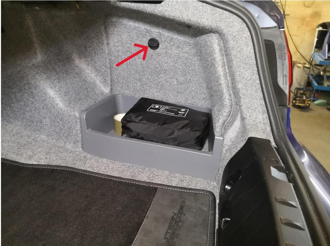
2. In Fahrtrichtung vor der Batterie befindet sich eine Durchführung.
