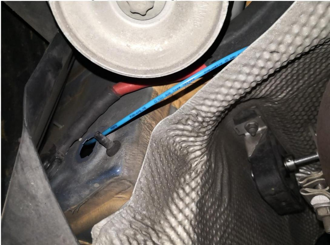
11. Ziehen das Kabel unter der Kofferraumverkleidung Richtung Rücksitzbank. Lösen Sie hierzu, wenn nötig die Verkleidung.
