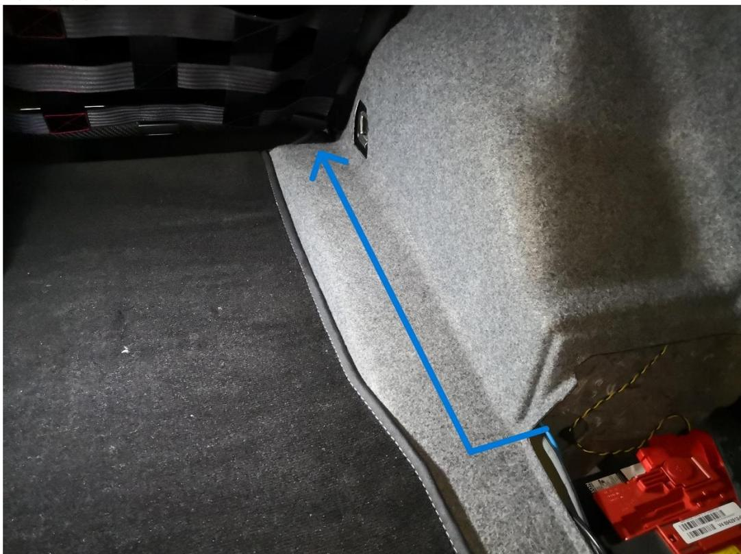
12. Entfernen Sie die Abdeckung der Einstiegsleiste auf der Beifahrerseite, hierzu muss die Leiste kräftig nach oben gezogen werden.
