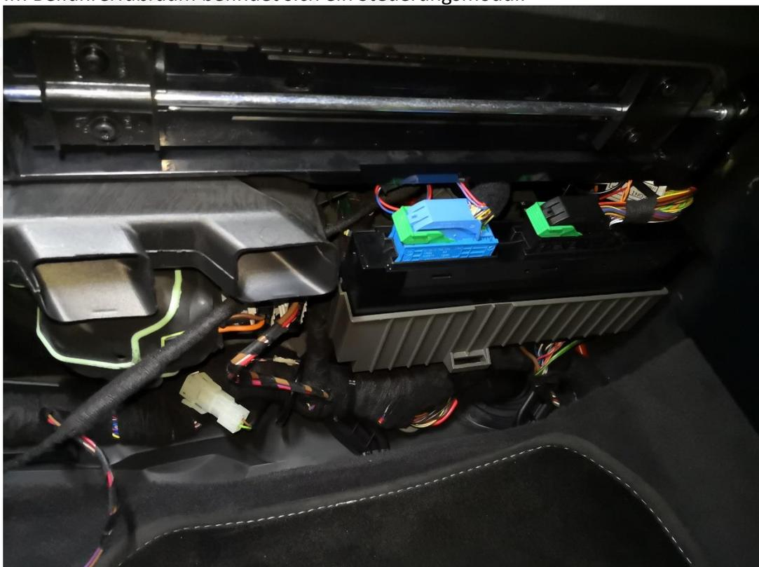
20. Von dem blauen Stecker führt ein verdrehtes Kabel weg. Hier muss die mitgelieferte Abzweigung wie folgt angeschlossen werden:
