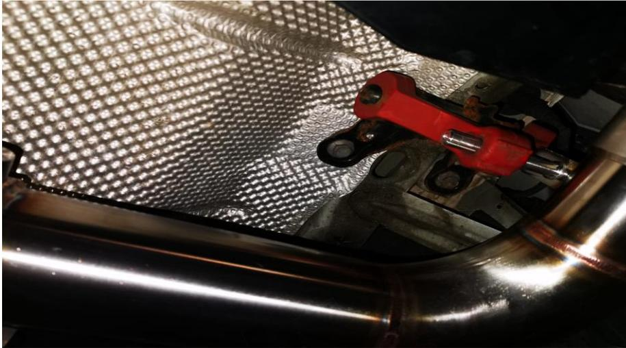
5. Die Endschalldämpferhälften ausrichten und die Schellen am Endschalldämpferverbinder anziehen.
