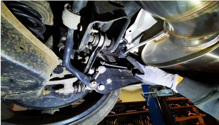
3. Die Schelle am Reduzierstück/ Mittelschalldämpfer anziehen.
