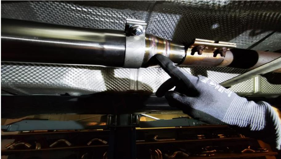
Nun kann der Mittelschalldämpfer eingesetzt werden. Wichtig!!! Gummi auf der rechten Seite muss entfernt werden.
