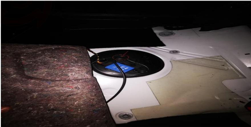
8. Das Kabel unter der Verkleidung zur linken Fahrzeugseite führen und dort unter der Einstiegsleiste verstecken.
