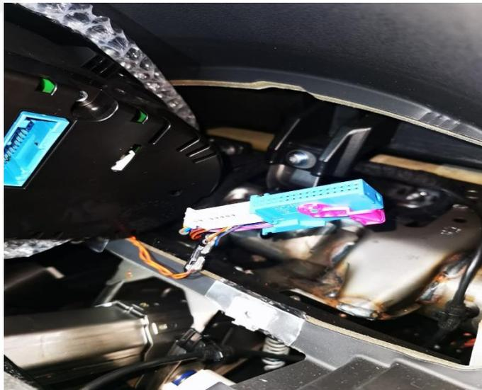
anschließend den Stromdieb an Braun (Pin4) (hinten) und Gelb (Pin5) (vorne) anschließen.
