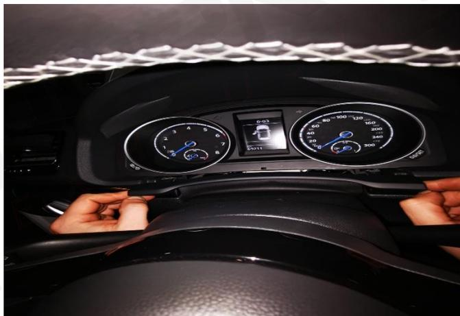
Die Schrauben am besten mit einem magnetischen Schraubenzieher herausnehmen.
