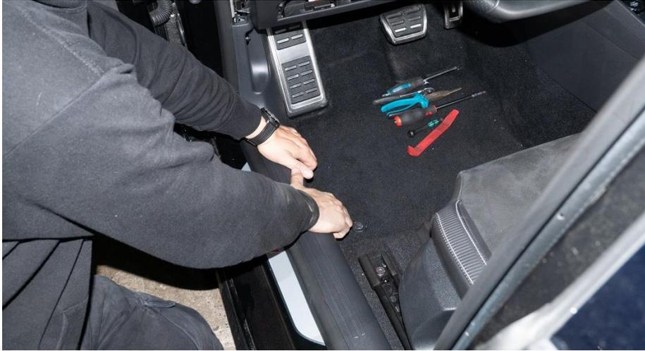
14. Das EWG-Steuergerät (ASR CB1 Modul) an der Seite des Armaturenbrettes verstauen (optional kann man es mit einem Kabelbinder sichern).
