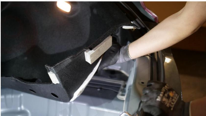
5. Die Isolierung vorsichtig entfernen. Es kann ein Messer dazu benötigt werden, um dies zu lösen. Wichtig: Keine Kabel beschädigen.
