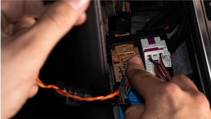
18. Das Kabel (Von den Klappen kommend) in das EWG-Steuergerät (ASR CB1 Modul) einstecken.
