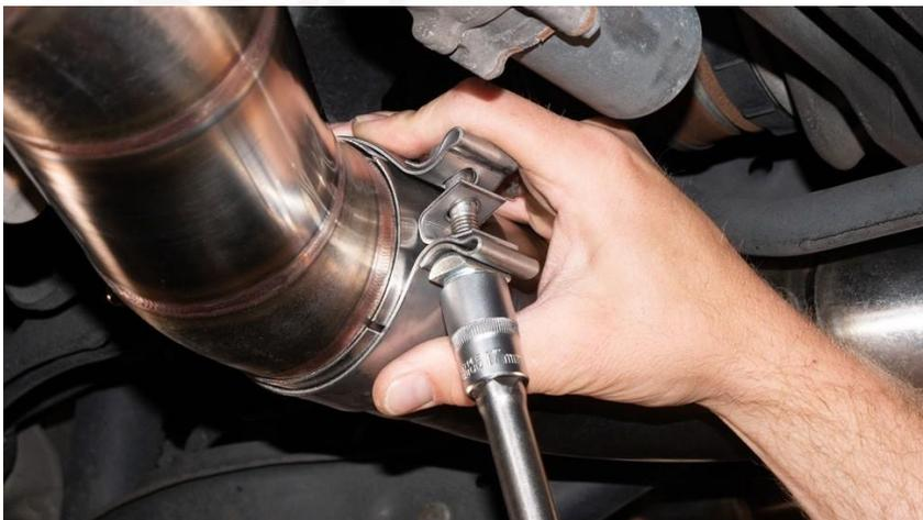
8. Die Endrohre aufsetzen und in die gewünschte Position ausrichten. So wie die Querstrebe wieder montieren.
