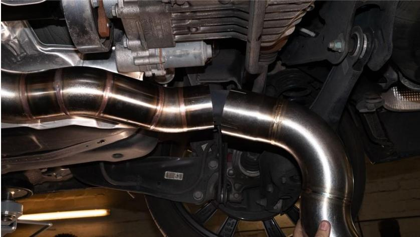
5. Die Schelle am Reduzierstück/ Mittelschalldämpfer anziehen.
