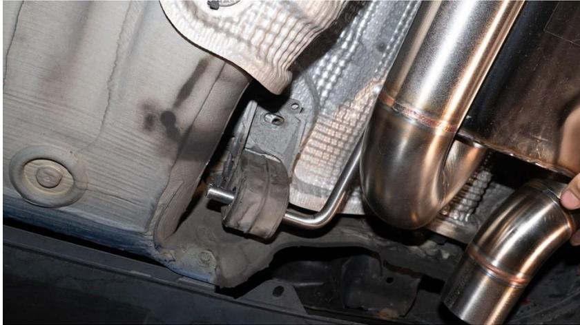
7. Die Endschalldämpferhälften ausrichten und die Schellen am Endschalldämpferverbinder (Y-Stück) anziehen.
