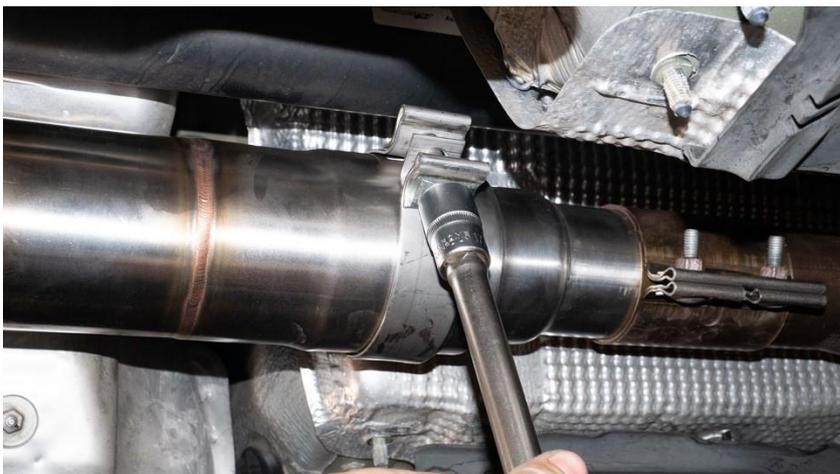
6. Die Endschalldämpferhälften aufsetzen und an den Auspuffgummis anschrauben.
