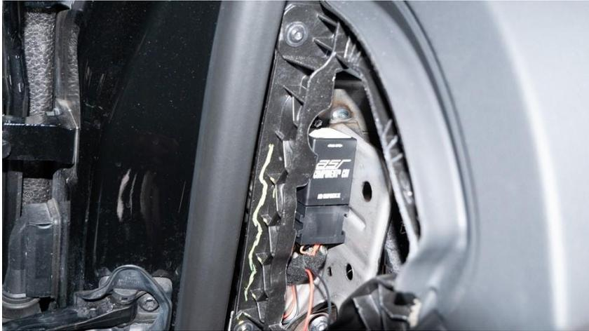
16. Das EWG-Steuergerät (ASR CB1 Modul) mit Masse verbinden und einer 7,5A oder 10A Sicherung sichern (dazu einfach eine vorhandene Sicherung herausziehen und mit dem Modulstecker zusammen wieder einstecken).
