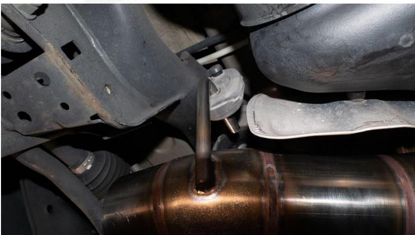
4. Nun wird der Endschalldämpferverbinder (Y-Stück) aufgesteckt.
