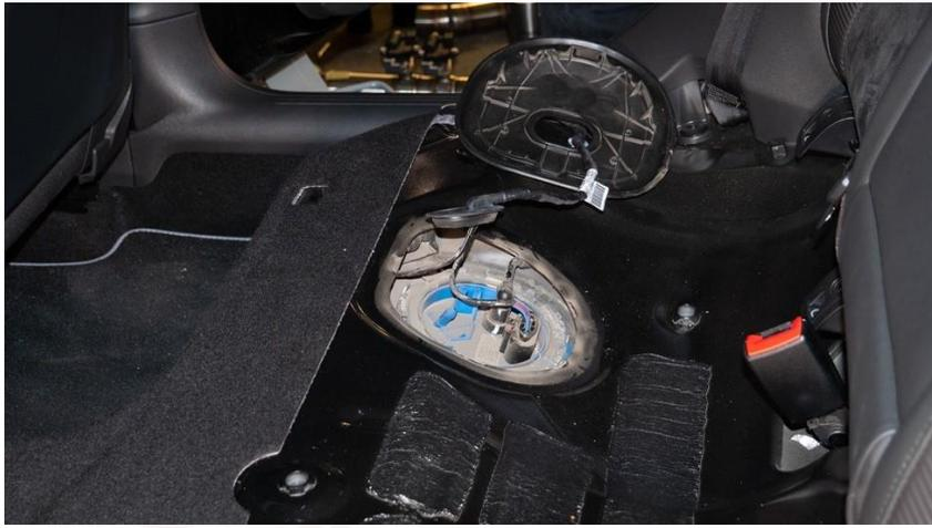
3. Nun eine Durchzugshilfe (Druckluftschlauch, Draht etc.) über den Tank Richtung Fahrzeugheck führen und nach unten herausziehen.
