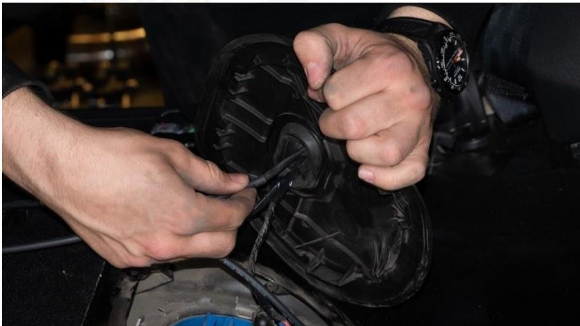
9. Das Kabel unter der Verkleidung zur linken Fahrzeugseite führen und dort unter der Einstiegsleiste verstecken.
