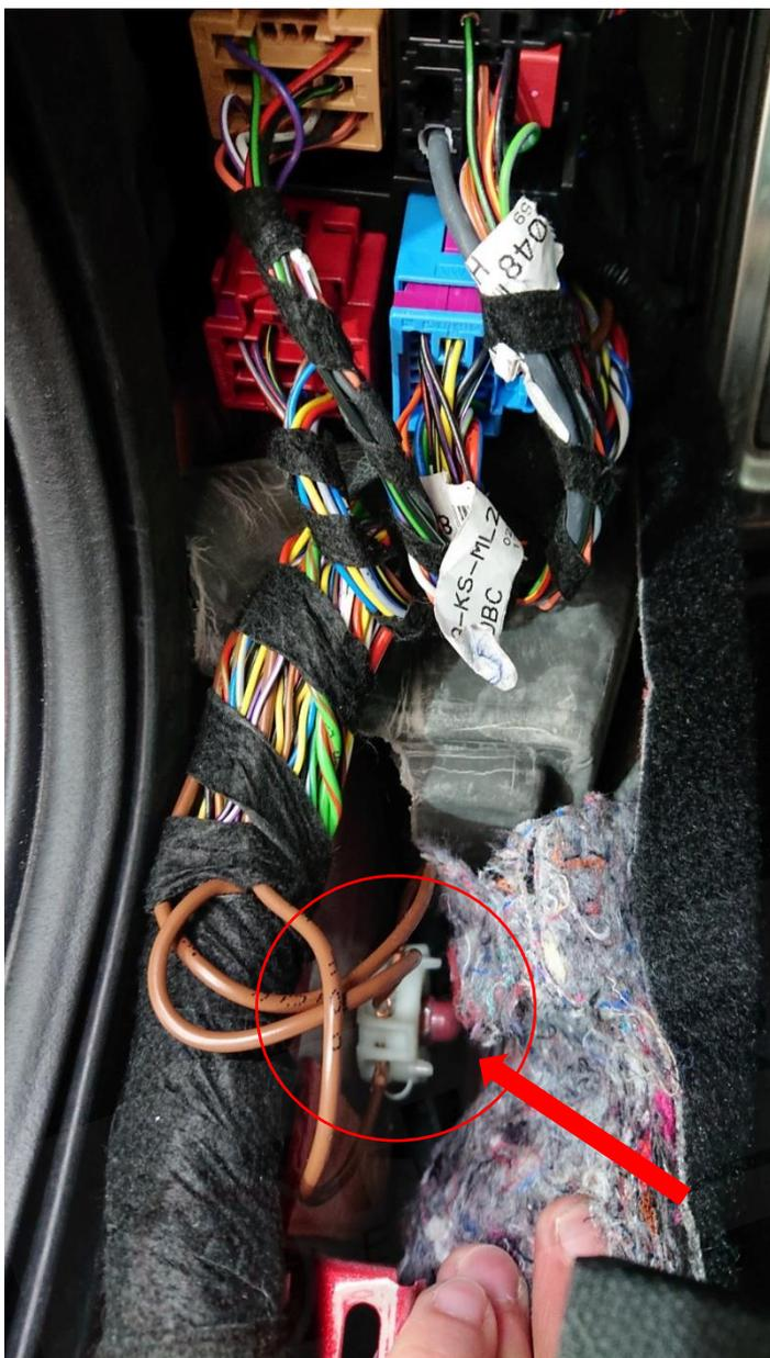
Um das Modul mit Strom zu versorgen, muss die Hutmutter mit der Karosserie verbunden werden. Hierzu im Fußraum die Verkleidung zurückziehen und die Hutmutter mit dem Gewindestift verbinden. Anschließend alles sichern und wieder zusammenbauen.
