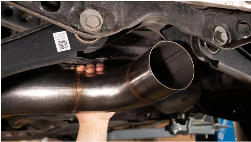
(ST V3:ST: Nun wird der Endschalldämpferverbinder (Y-Stück) aufgesteckt
