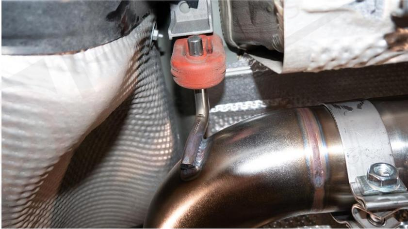
!!!: Die Auspuffgummis sollten senkrecht zum Boden stehen. Wenn diese weit nach vorn oder hinten stehen ist die Anlage noch nicht komplett zusammengesteckt.
