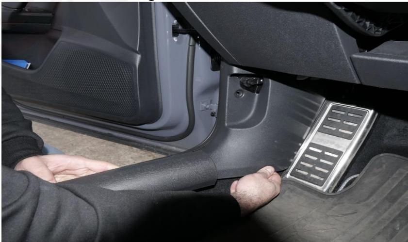
4. Das EWG-Steuergerät (ASR CB1 Modul) an der Seite des Armaturenbrettes verstauen (optional kann man es mit einem Kabelbinder sichern).
