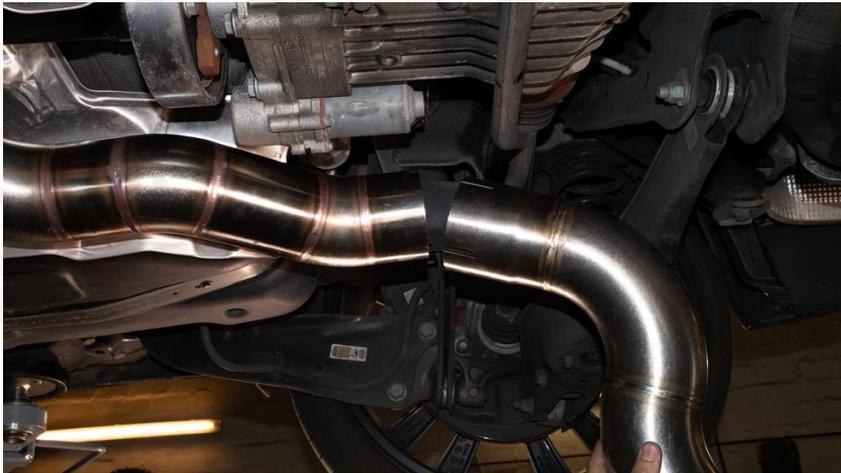
ST: Die Endschalldämpferhälften aufsetzen und an den Auspuffgummis anschrauben.
