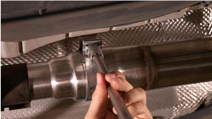
7. Die Endrohre aufsetzen und diese in Wunschposition ausrichten (V2/ V3: Ebenso denn Endschalldämpfer hinten rechts auf die richtige Höhe einstellen (der Auspuffhalter wird mit zwei Muttern gesichert)).
