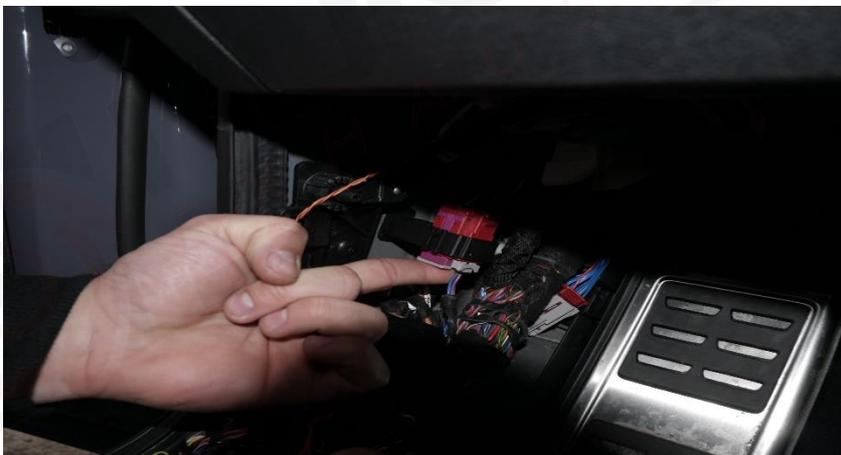
8. Nun muss das EWG-Steuergerät (ASR CB1 Modul) in die BUS-Steuerung eingefügt werden. Detailliertere Instruktion dazu auf dem beigefügten Dokument für die Pinbelegung.
