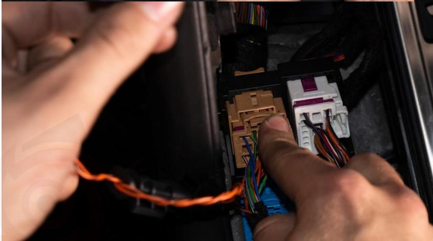
9. Das Kabel (Von den Klappen kommend) in das EWG-Steuergerät (ASR CB1 Modul) einstecken.
