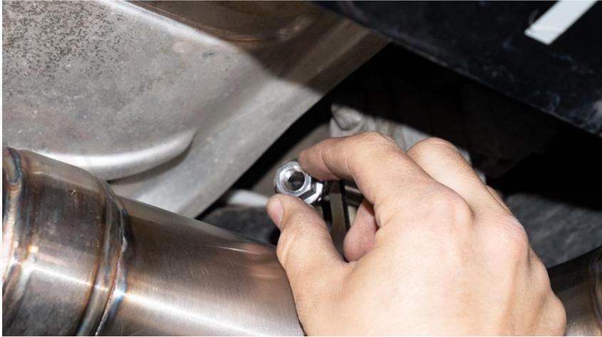
8. Die Schelle am Endschalldämpfer anziehen. Sowie die Querstrebe montieren.
