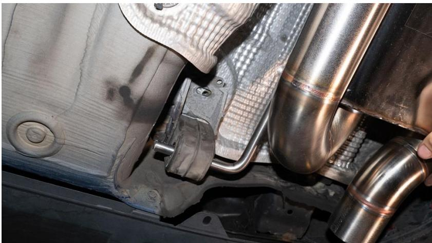
ST: Die Endschalldämpferhälften ausrichten und die Schellen am Endschalldämpferverbinder (Y-Stück) anziehen.)
