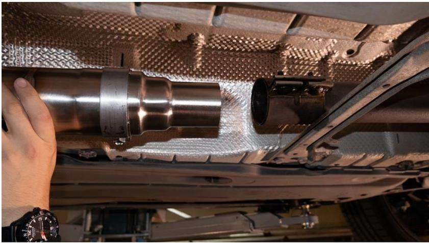
4. Den Mittelschalldämpfer ansetzen und hochdrehen. Ein zweites Auspuffgummi (im Lieferumfang enthalten) muss vorab angebracht werden.
