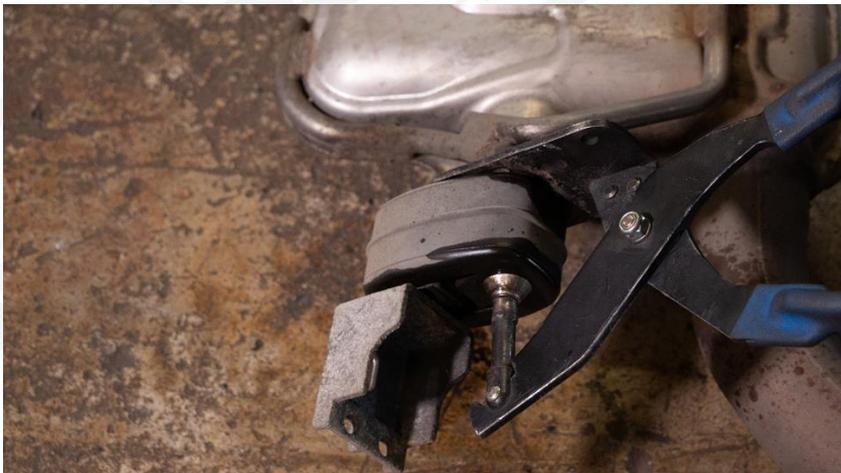
3. Anlage montieren. Beginnend mit Reduzierstück und dem Verbindungsrohr zum Mittelschalldämpfer.
