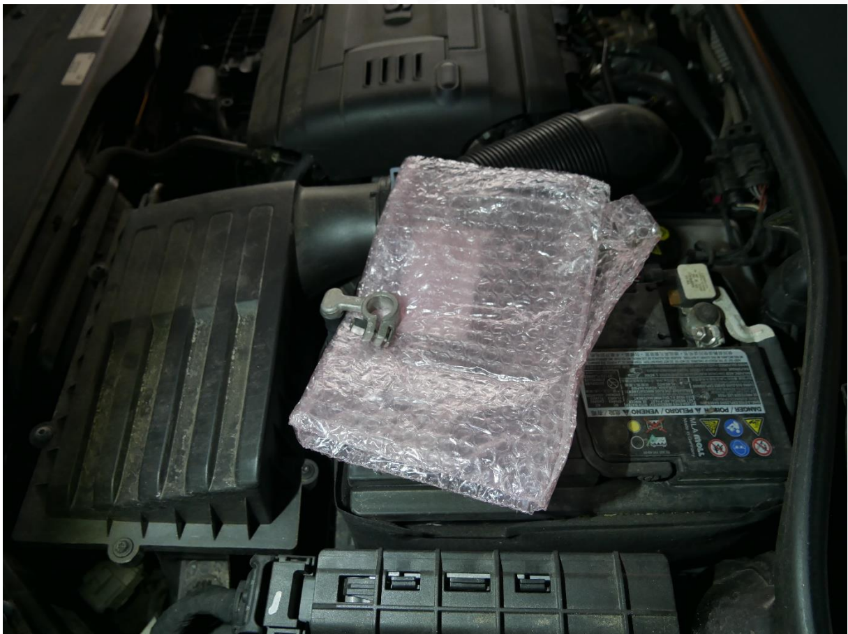
Als nächstes die Batterie abklemmen – am besten eine Tüte oder einen nicht leitfähigen Stoff darunterlegen, um mögliche Kontakte zu vermeiden!
