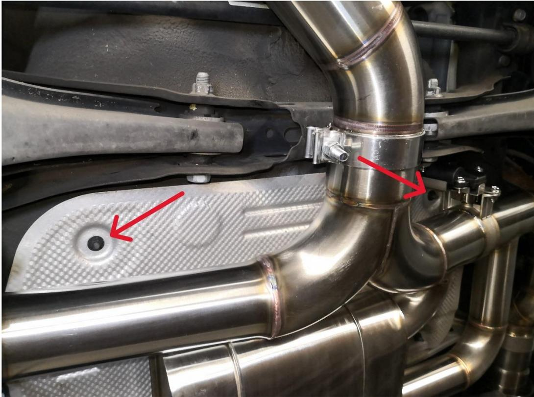
12. Schließen Sie das beigefügte Y-Kabel an den vier-poligen Stecker an und verlegen Sie das Kabel oberhalb des Hitzeschutzbleches zu den beiden Stellmotoren. Achten Sie auf ausreichenden Abstand zur Abgasanlage und befestigen Sie das Kabel, wenn nötig an geeigneten Stellen.
