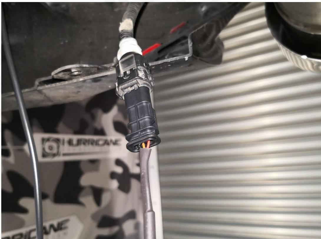
11. Lösen Sie beiden rot markierten Muttern des Hitzeschutzbleches.
