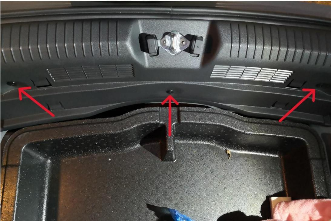
4. Nun wird die Seitenverkleidung ausgebaut. Hierzu entfernen Sie die **rot** markierten Schrauben und den **grün** markierten Clips. Als Nächstes entnehmen Sie die **blau** markierten Abdeckungen, um die dahinter liegenden Schrauben herauszudrehen.
