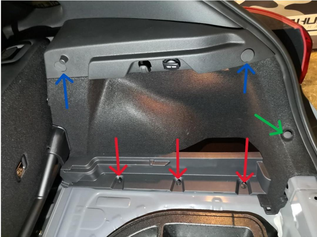
5. Entriegeln Sie den rechten Teil der Rücksitzbank und klappen Sie diese nach vorne. Die Seitenverkleidung kann nun gelöst werden.
