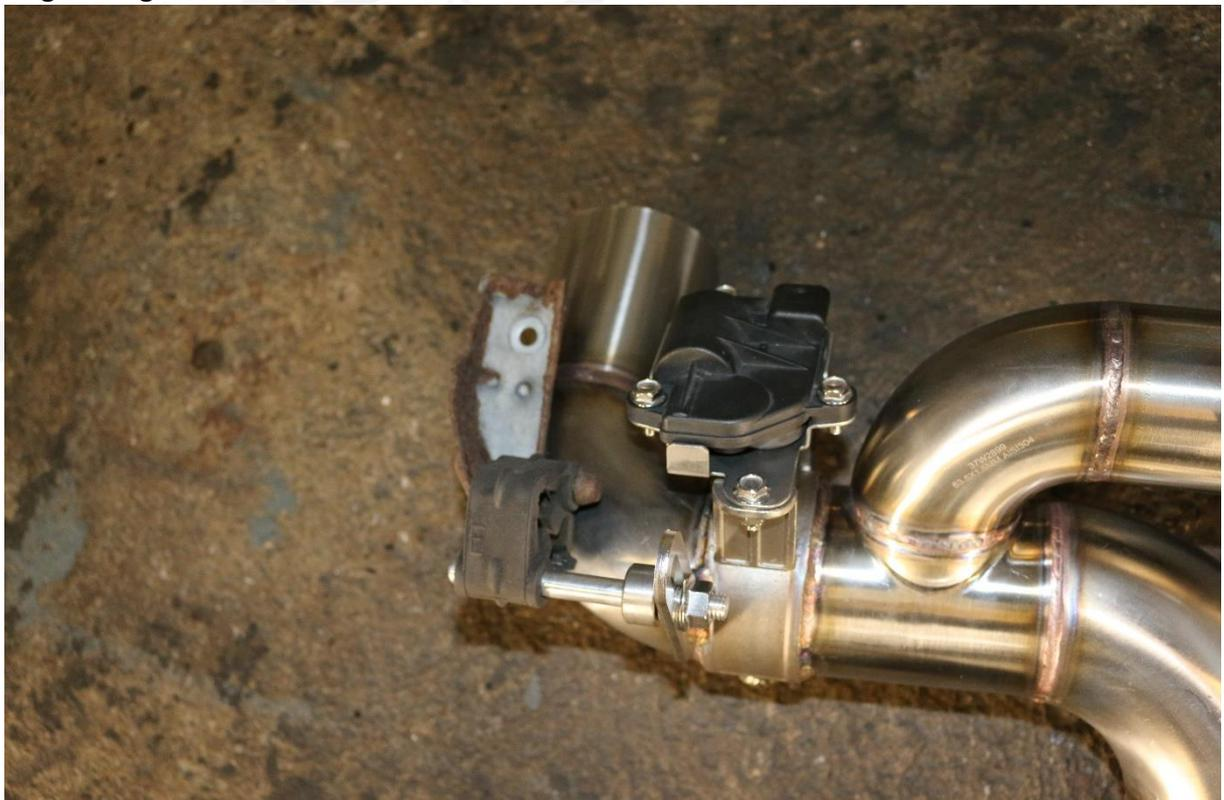
6. Demontieren Sie die drei originalen Abgasanlagenhalter.
