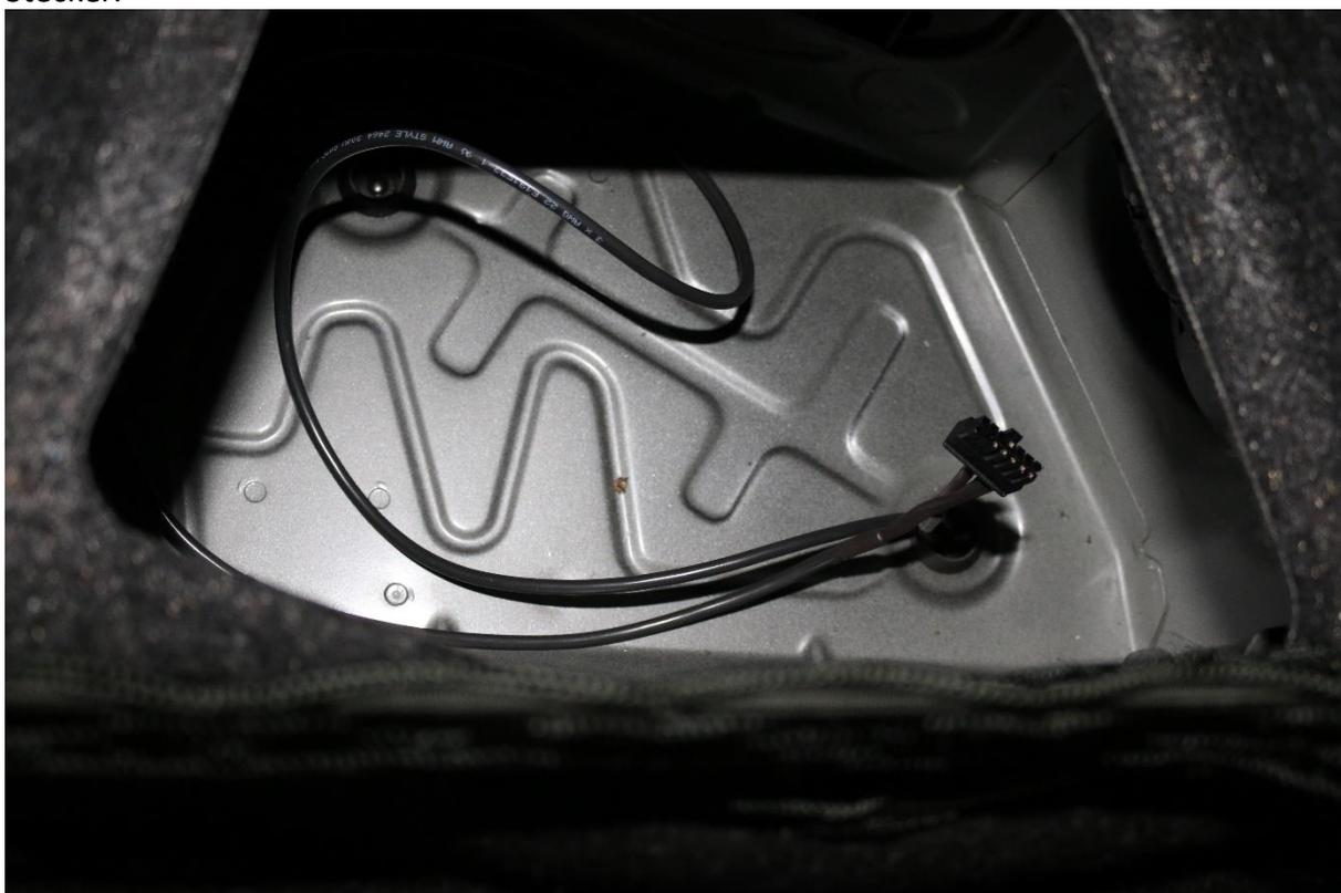
15. Der 4-polige Stecker wird ca. 30cm aus dem Fahrzeug herausgeführt. Die 4-polige Buchse wird entlang der originalen Kabelführung in der Heckschürze auf die Fahrerseite geführt. Dort wird Sie mit dem Kabelbaum, des originalen Stellmotors verbunden.
