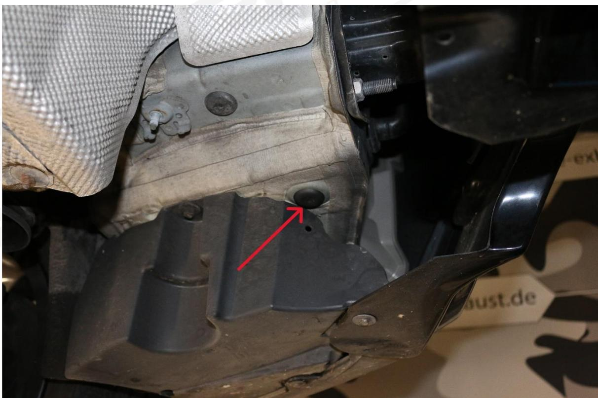
14. Bearbeiten Sie den Gummistopfen, sodass sie den Kabelbaum von außen in den Innenraum führen können. Entfernen Sie hierzu das Steuermodul vom 14-poligen Stecker.
