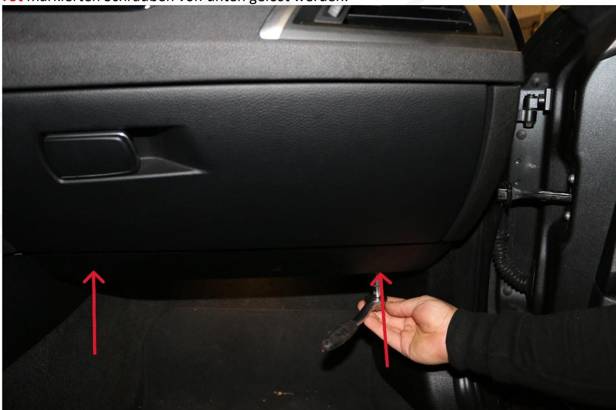
21. Demontieren Sie die rechte Abdeckung, um die Elektronik freizulegen.
