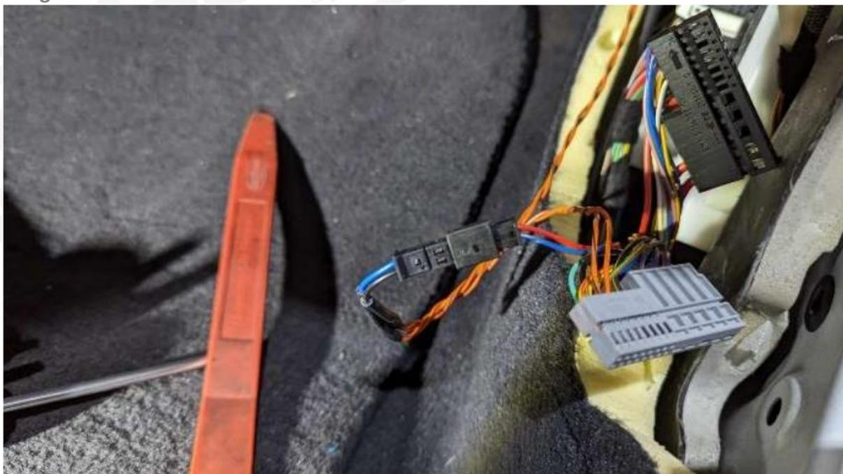
28. Verlegen Sie das Kabel quetschfrei entlang der **rot** markierten Linie in der Einstiegsleiste zur B-Säulenverkleidung. Von dort aus unter der Rücksitzbank unter die Kofferraumverkleidung bis zum Staukasten beifahrerseitig. Schließen Sie hier das Kabel an das Steuermodul an und verstauen das überschüssige Kabel.
